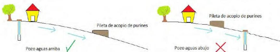
Figura 2.1: Esquema de correcta instalación de una perforación (izquierda) e incorrecta ubicación (derecha)
